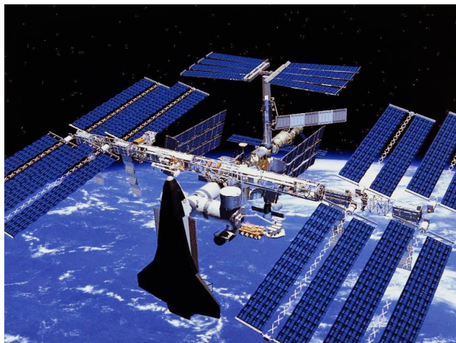
Fig. 11: La ISS orbita a 400 km de altura a 7.66 km/s y orbita 15.56 veces alrededor de la Tierra en un día.
