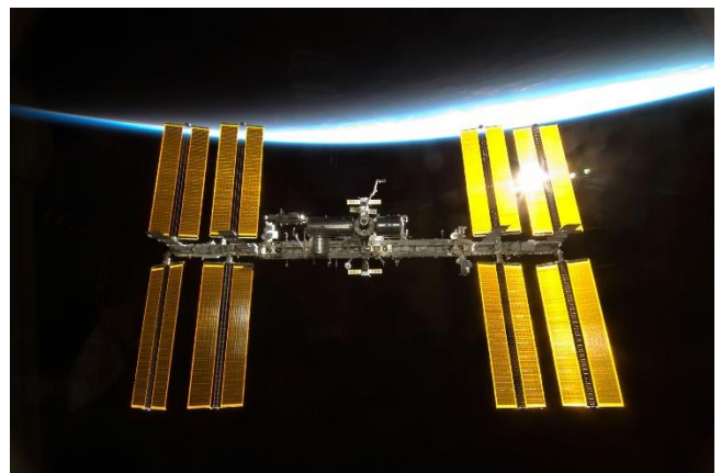
Fig. 20: La ISS orbita a 400 km de altura a 7.66 km/s y orbita 15.56 veces alrededor de la Tierra en un día.
